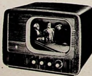
Bild 3. Philips-Fernseh-Tischempfänger 1420 U, bei dem durch Nebeneinander-Anordnung von Bildröhre und Lautsprecher eine besonders gefällige Form erzielt wurde
