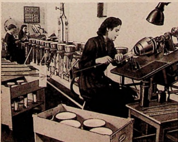
Bild 5. Aufbringen des leitenden Innenbelages (Schwärzung) im Kolben von Oszillografenröhren
