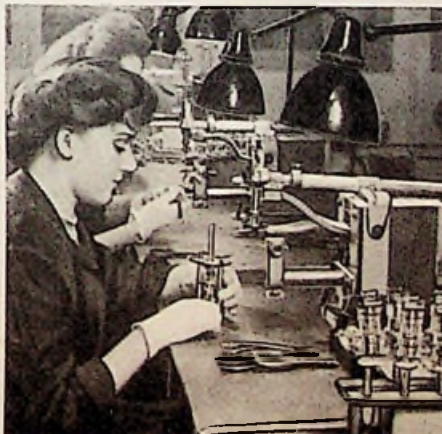
Bild 3. System-Montage der Oszillografenröhrenfertigung (Bilder aus der Telefunken-Fertigung)
